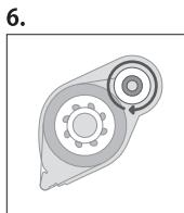
図のように巻取部品を回転させ、目印のテープが先端ローラーを通り過ぎるまで回します。
