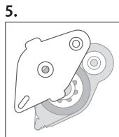
支持部品を図のように取り外してください。(テープが先端部分より外れた時は直してください。)
