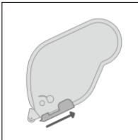
図のようにキャップを“カチッ”と音がするまでスライドさせ、固定してください。
