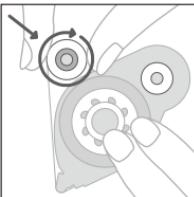
“巻出部品”的回転を止めておいたまま、“巻取部品”だけを時計回りに回転させて、ピンと張るまでテープのたるみを取るように巻き上げてください。
