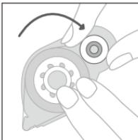
図のように“巻出部品”的回転を止めておいたまま、テープが張った状態を保持しつづけ“巻取部品”を元の位置にセットしてください。その後カバーを閉め、ロック部分を“CLOSE”的方向に回転させて下さい。
