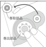
“巻出部品”を押させて、“巻取部品”を上部に引き上げて取り外してください。
