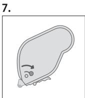
カバーを元通りに戻し、ロック部分を“CLOSE”的方向に回転させてください。(ロックを戻し忘ると、使用中にカバーが開くことがあります。)
